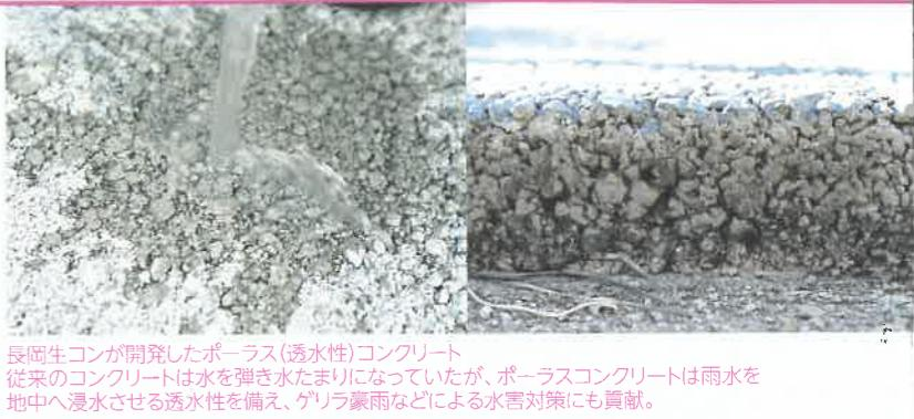
長岡生コンが開発したポーラス(透水性)コンクリート
