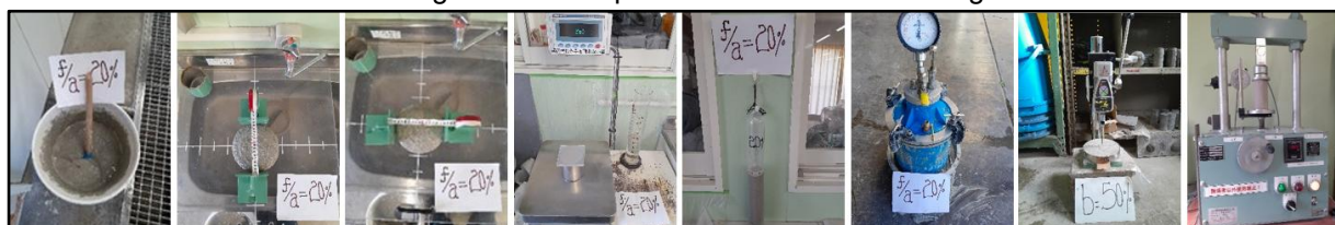
a) Fresh CLSM b) Flowability c) Wet density d) Bleeding e) Air content f) Penetration g) Strength
